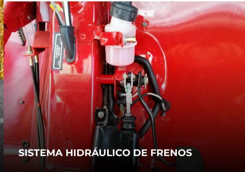
**SISTEMA HIDRÁULICO DE FRENOS**
